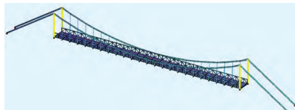
Fig. 9. FEM Model visualization (SOFiSTiK)
